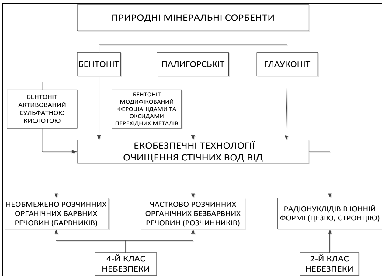
Рис. 1. – Класифікація використання природних та модифікованих сорбентів в технологіях очищення стічних вод від забрудників 2-4-го класу небезпеки.
