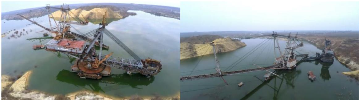
Рис. 2. «Долина гігантів»: роторний екскаватор та конвеєрна стрічка (біля м. Олександрія) [1]
